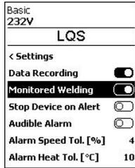
Ist Monitored Welding eingeschaltet, werden Grenzwert-überschreitungen der aufgezeichneten Schweissparameter protokolliert.
