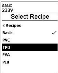
Wählen Sie mit den Tasten Minus/Plus (32) das gewünschte Rezept aus. Durch Drücken der Taste Bestätigen (33) wird das entsprechende Rezept übernommen. Verlassen des Menü durch Betätigen der Taste Menü (34). Es erscheint der Hinweis, dass eine Testschweißung durchzuführen ist.
