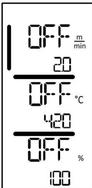
Sofern das Gerät vorgängig abkühlen konnte, folgt eine statische Anzeige der Sollwerte der zuletzt eingestellten Schweissparameter.
