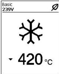
Nach Ablauf des Standby-Timers ohne Aktivität wird der Abkühlvorgang eingeleitet. Sie können den Vorgang mit der Taste *Heizung Ein/Aus* (31) unterbrechen.
