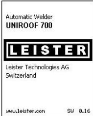
Nach dem Starten wird im Display für kurze Zeit das **Startbild** mit der Versionsnummer des aktuellen Software Release und die Gerätebezeichnung angezeigt.
